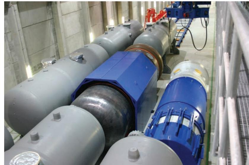
Rechts: Reaktordruckbehälter (RDB) des KKR in der Halle 7 des ZLN
