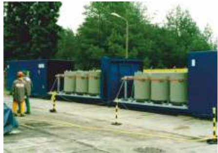
Abfallgebinde im Transportcontainer
