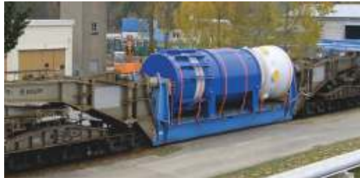
Verladung - RDB mit Abschirmung (blau) auf einen Schwerlastwagon
