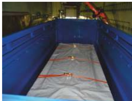
Containerbeladung - Transportwanne mit Teilstück RWB
