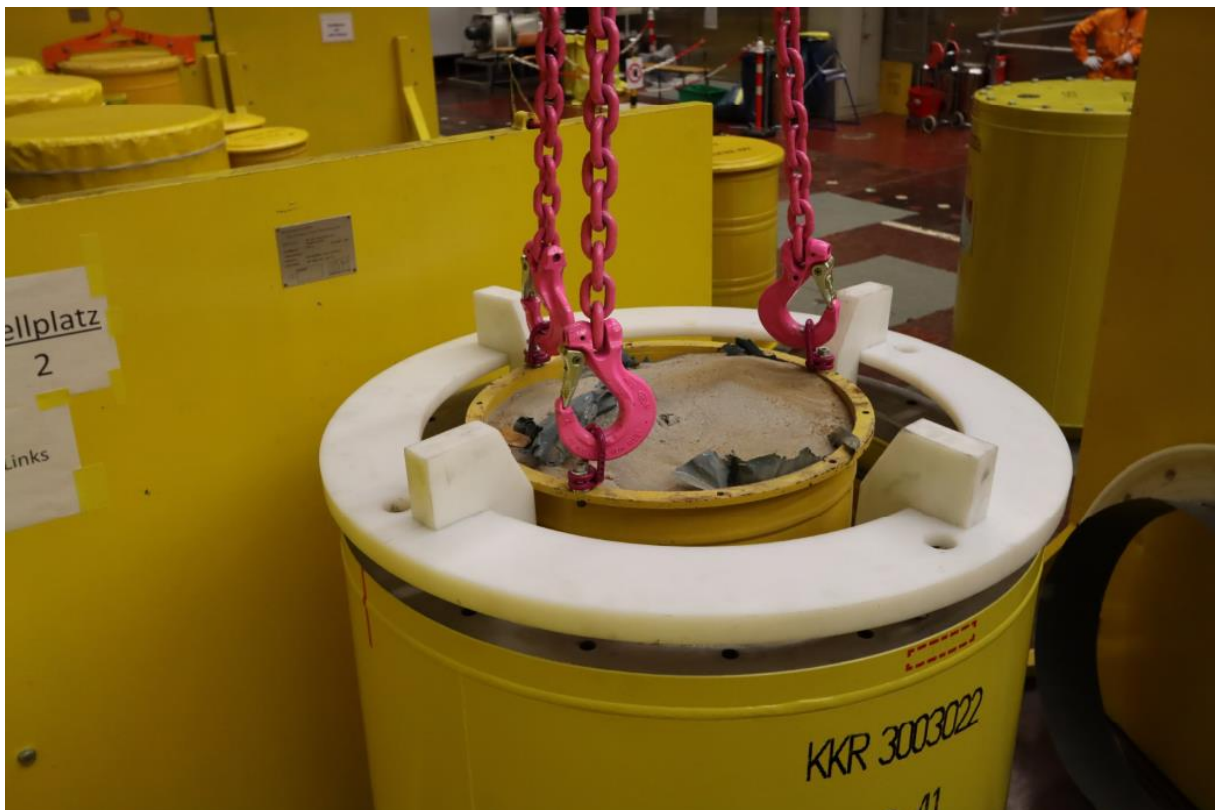
Umladung Heißzellengebinde aus Verlorenen Betonabschirmungen in Ummantelte Betonabschirmungen
