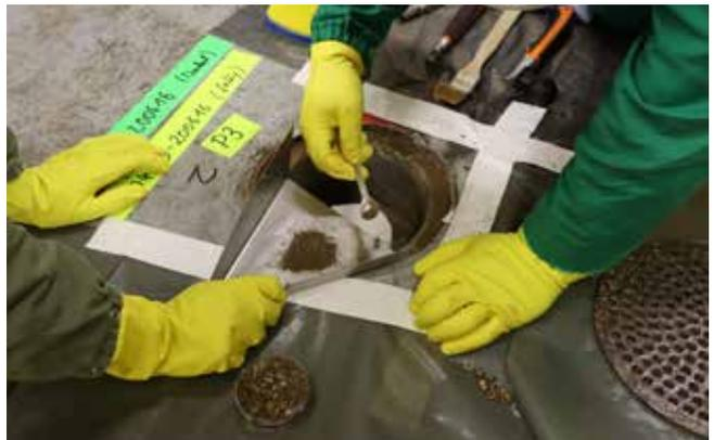
Probenahme zur Neubestimmung der KKR-Nuklidvektoren
