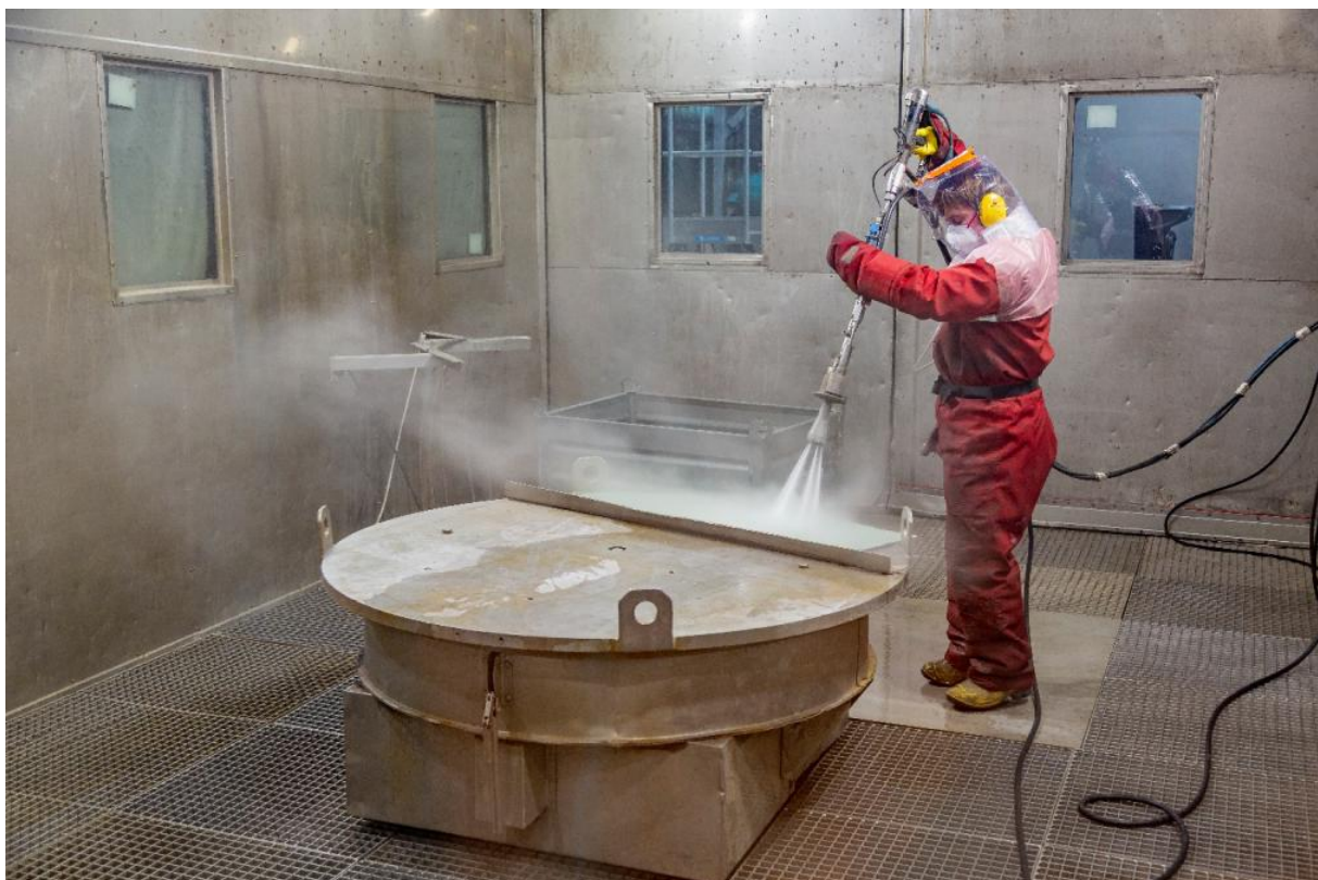
Hochdruckwasserstrahlen in der ZAW
