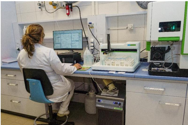
Messung Kesselinhaltswasser der WEA-Dampf mit ICP-OES (u.a. Kationen, wie Eisen (Fe), Calcium (Ca) oder Magnesium (Mg))
